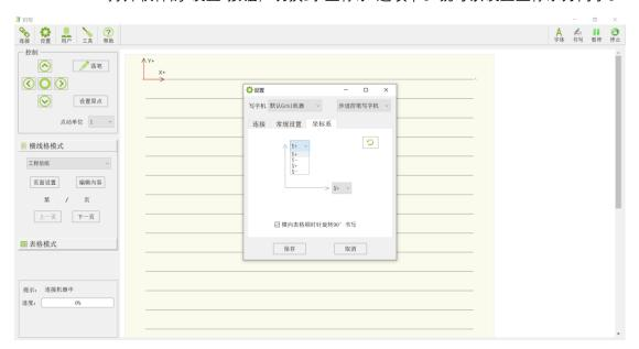
只需要点击两个坐标轴箭头的下拉框即可修改坐标系。图中是软件默认坐标系。假如向上的箭头切换到 X+,则右边的箭头下拉框自动更换内容为 Y+Y-用于选择。点击右上角的刷新按钮即可重置为默认坐标系。
