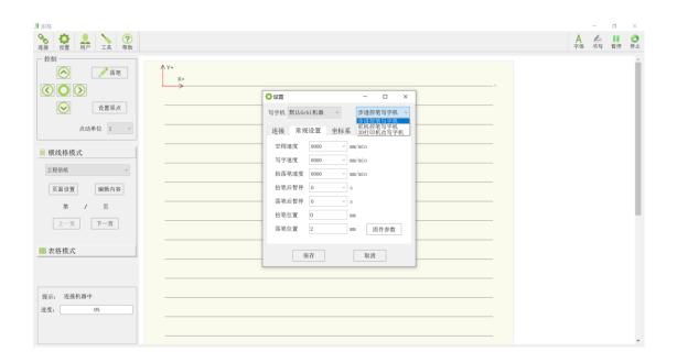
步进控笔:步进电机抬笔速度很快,可以实现高速书写。一般默认开机后抬笔位置为 0,方便初始化抬笔位置。落笔位置根据机器不同而不同。抬笔落笔位置代表抬笔落笔的高度。抬笔速度是抬笔落笔的点击响应速度。、
